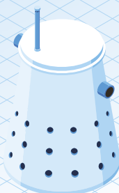
VSAKOVACÍ ŠACHTA INFILTRATION MANHOLE
